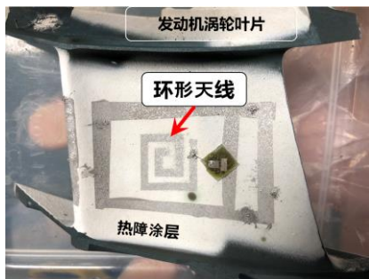
航空发动机涡轮叶片表面TBC上制作的近场天线与SAW
